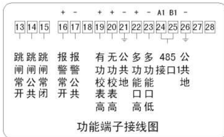
图 7A 外置继电器电能表 485 辅助端子排列图
