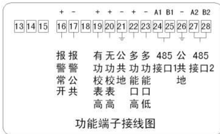
图 7D 内置继电器电能表双 485 辅助端子排列图
